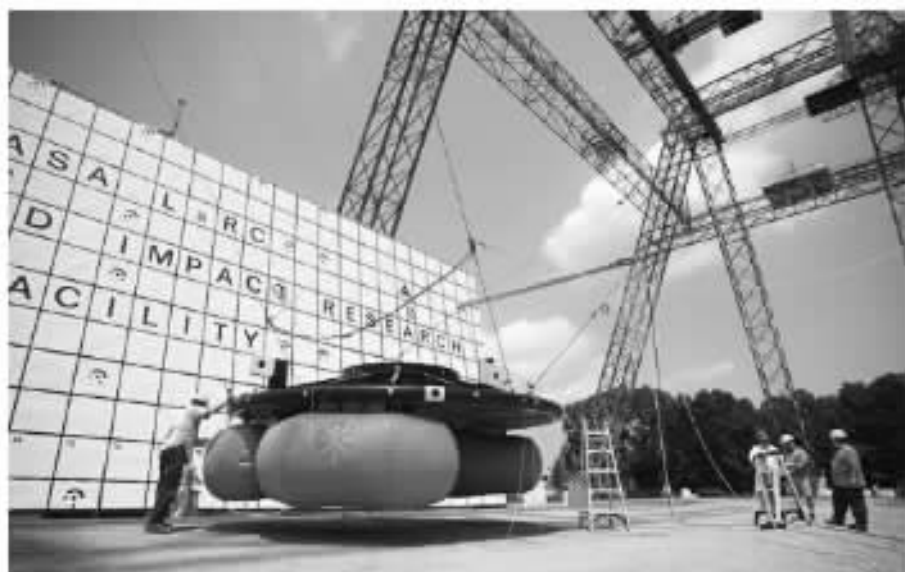
图 7 NASA 工程师正在测试可充气式气囊系统
