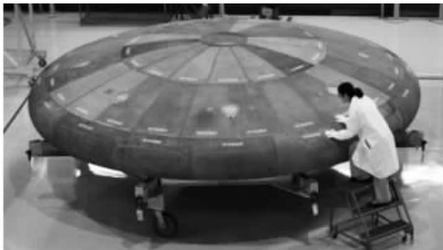
图 8 波音公司为“猎户座”飞船制造的热防护罩
